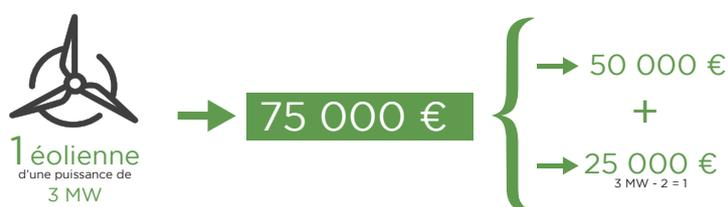
Cette formule couvre le coût total du démantèlement déduit de la vente des composants des éoliennes aux filières de revalorisation (acier, béton, etc.). En effet, la réglementation impose une valorisation de 90 % de la masse de l'éolienne depuis le 1er juillet 2022.
